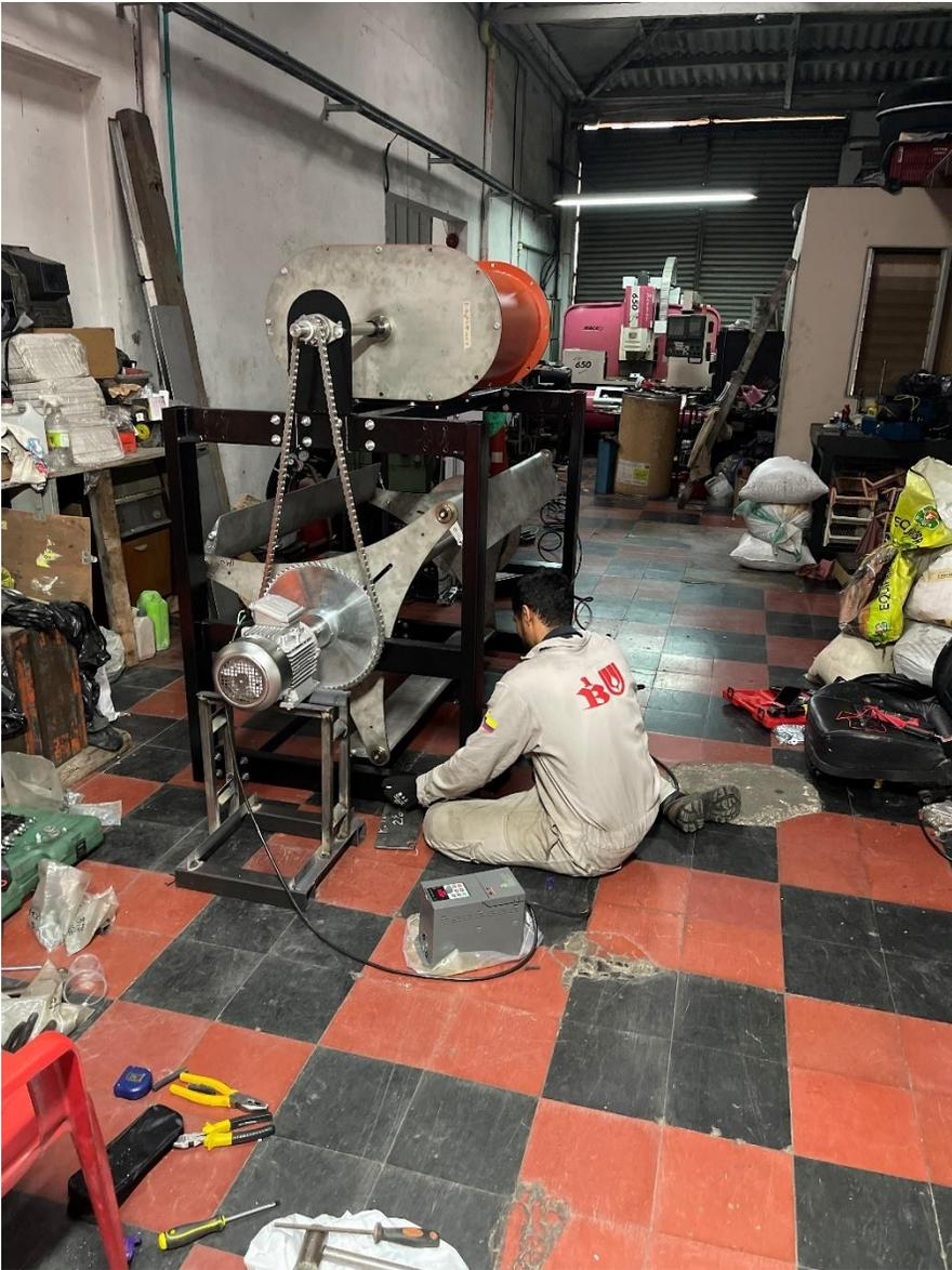
Figura 2 Imagen del equipo de prueba conectado al variador
