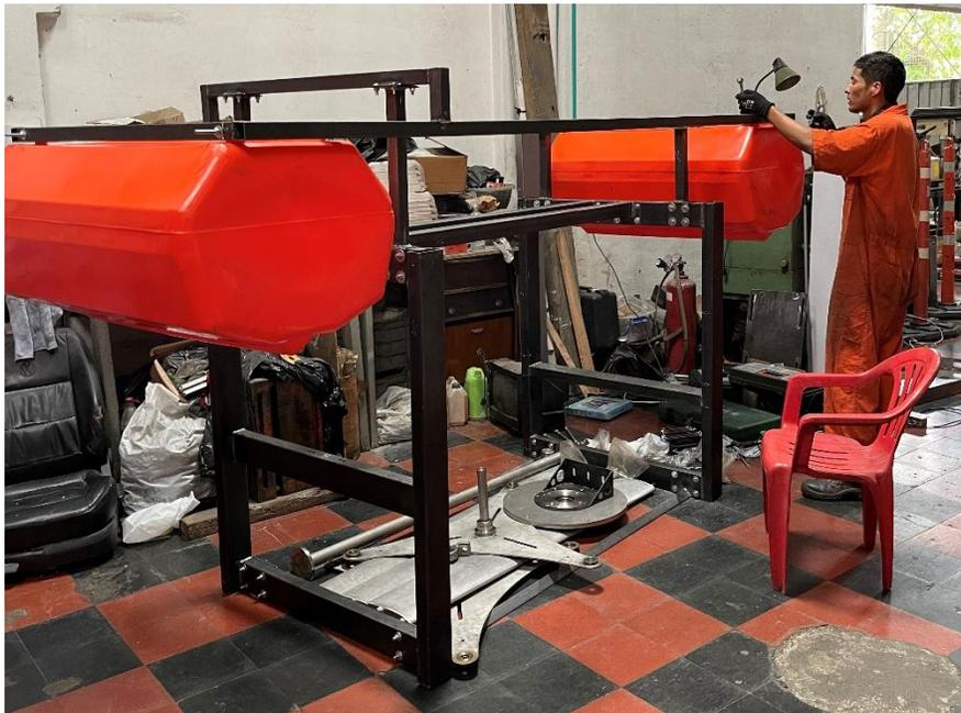
El subsistema de transmisión mecánico es el responsable de transmitir la potencia mecánica de la turbina al alternador. Para ello el subsistema cuenta con dos piñones y una cadena que presentan una relación de reducción de 1:6 para disminuir el torque y aumentar las RPM. Este subsistema
